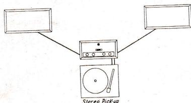
Unica Stereo forstærker type 7046 er en 2-kanalforstærker, der kan anvendes både til stereo og monaural gengivelse. I forstærkerens indgang er anvendt den nye standard Stereo pick-up dåse, hvis princip er udviklet af os. Enhver stereo krystal pick-up, der er forsynet med denne standard Stereo stikprop kan anvendes. Tilsluttet en almindelig pick-up kobles forstærkerens 2 kanaler i parallel, så den dobbelte udgangseffekt opnås.
